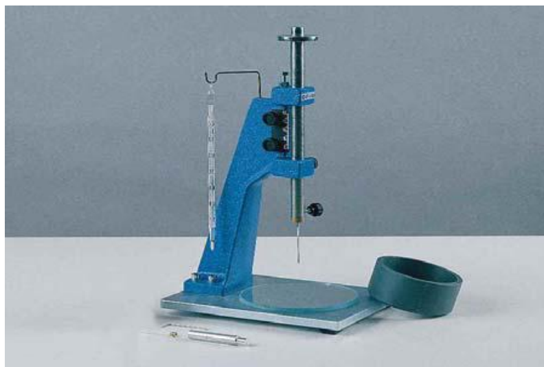
Figure I.10 :Détermination du temps de début de prise.
